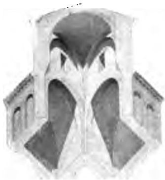
Fig. 75. — Coupole sur pendentifs, Ravenne. Tombeau de Galla Placidia, d'après Choisy.
